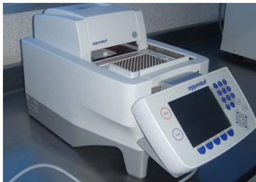
**Figura 17.** Termociclador de gradiente Mastercycler® ep Eppendorf AG Hamburg.
