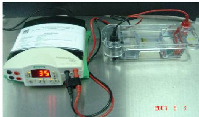
**Figura 15.** Cámara de electroforesis (BIORAD MINI-SUB® Cell), y fuente de poder (BIORAD) utilizada para la corrida del gel.
